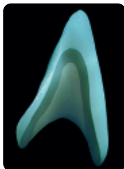
2 | Ceramica di altro produttore su ZrO 2 con luce passante
